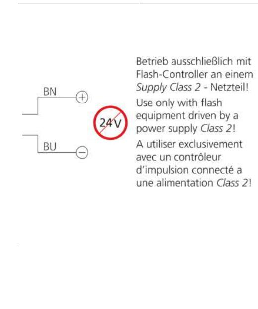
Betrieb ausschließlich mit Flash-Controller an einem Supply Class 2 - Netzteil!
